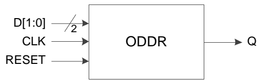
图 3-14 I/O 逻辑的 DDR 输出示意图
