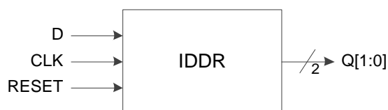
图 3-13 I/O 逻辑的 DDR 输入示意图
